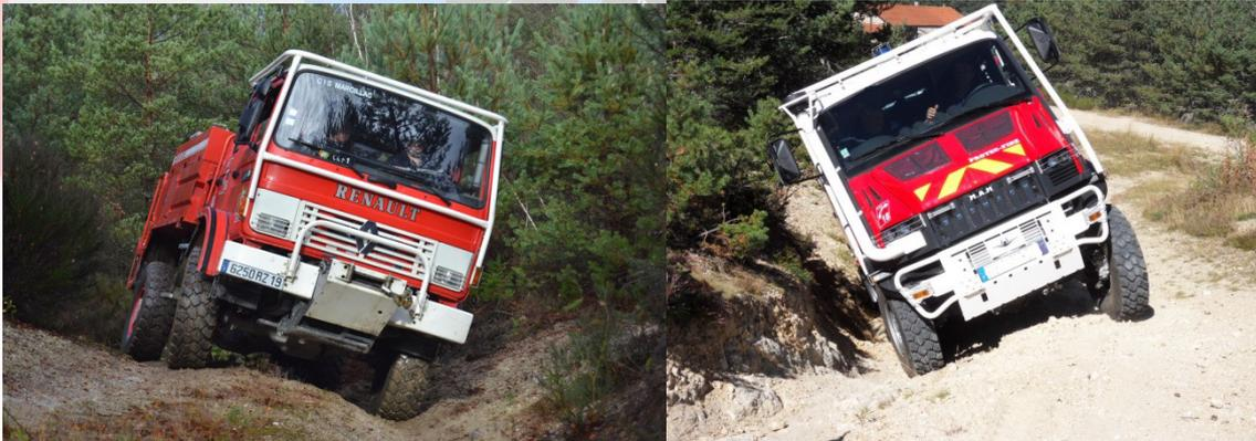
Le conducteur doit apprécier la déclivité du terrain selon le principe enseigné ou avec une cordelette et il ne s'engagera qu'après s'être assuré de pouvoir franchir l'obstacle en totalité et en toute sécurité .Pour des raisons de sécurité, le conducteur se limitera à des franchissements de dévers de maximum 30% voire moindres en fonction des données constructeur (*Souvent indiquées à bord de l'engin*).
